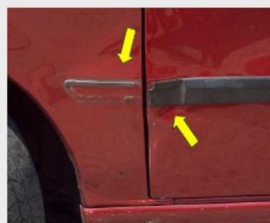
Amassados. Impactos profundos causando deformação nos frisos e guarnições.
