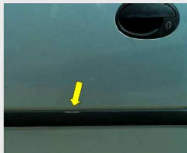
Riscos pequenos de até 100 mm, nos frisos e guarnições não pintados e nos frisos e guarnições pintados aqueles passíveis de remoção ou redução através de polimento
