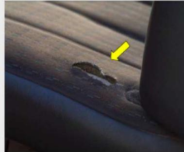
Bancos, consoles ou painéis furados, rasgados, queimados, ou com manchas que não possam ser removidas. Painéis furados para a colocação de alto falante, sem as devidas guarnições.
