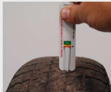
Pneus que tenham atingido o momento de troca, ou seja, a profundidade dos sulcos da banda de rodagem inferior a 1,6 mm. A indicação do momento de troca é verificada pelas marcações do TWI (Tread Wear Indicators).
