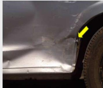
Amassados profundos causando deformação na lataria, ou desalinhamento de painéis.
