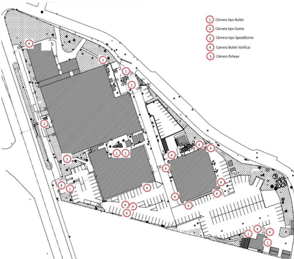
Figura 06 - Esboço de posicionamento de câmeras para áreas externas de todos os blocos;
