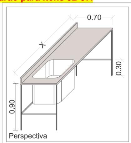
**32 – Módulo de inox com 01 tanque e sem prateleira inferior – medidas (L: 0,70Mts x A: 0,90Mts x Comp.: 1,00Mts).**
