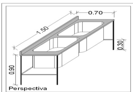
**38 – Módulo em inox com 02 tanques e sem prateleira inferior – medidas (L: 0,70Mts x A: 0,90Mts x Comp.: 1,50Mts).**
