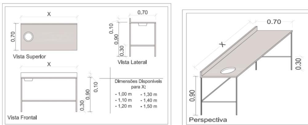
**26 – Módulo de inox com furos para detritos – medidas (L: 0,70Mts x A: 0,90Mts x Comp.: 1,00Mts).**
