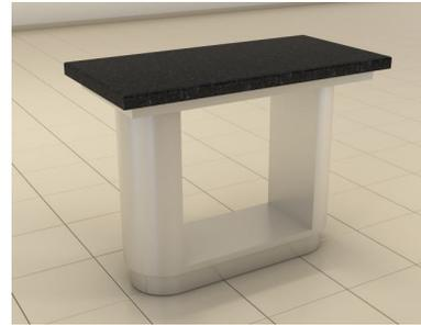
Balcão neutro de parede com tampo superior em granito polido na cor Preto São Gabriel, 2 cm de espessura, com saia de 3cm no mesmo padrão de pedra citada acima. Corpo inferior com revestimento externo em chapa de aço inoxidável AISI 304, liga 18.8 e reforço interno em metalon 30x20cm. Pés e rodapés em formato semi-circular, reforço interno em metalon 30x20cm e revestimento externo em aço inox AISI 304, liga 18.8. Sapatas de nivelamento em polipropileno.
